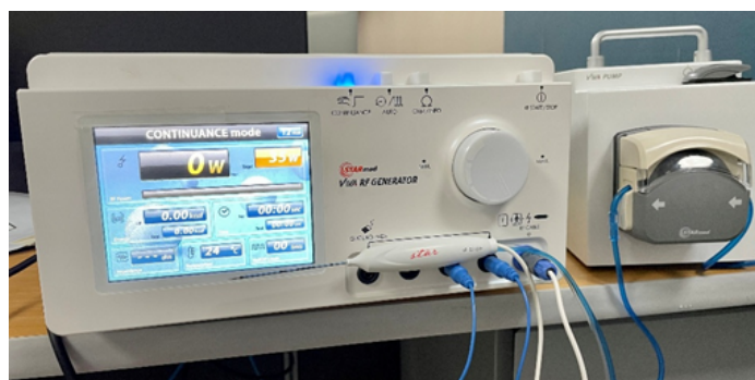
Figura 3: Consola generadora de radiofrecuencia a la izquierda, conectado a la aguja emisora de energía. A la derecha se encuentra la bomba de perfusión salina de enfriamiento.
